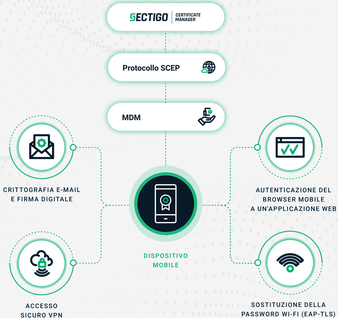
Figura 4 – SCM utilizza SCEP per passare i certificati all'MDM che li installa nel dispositivo mobile
