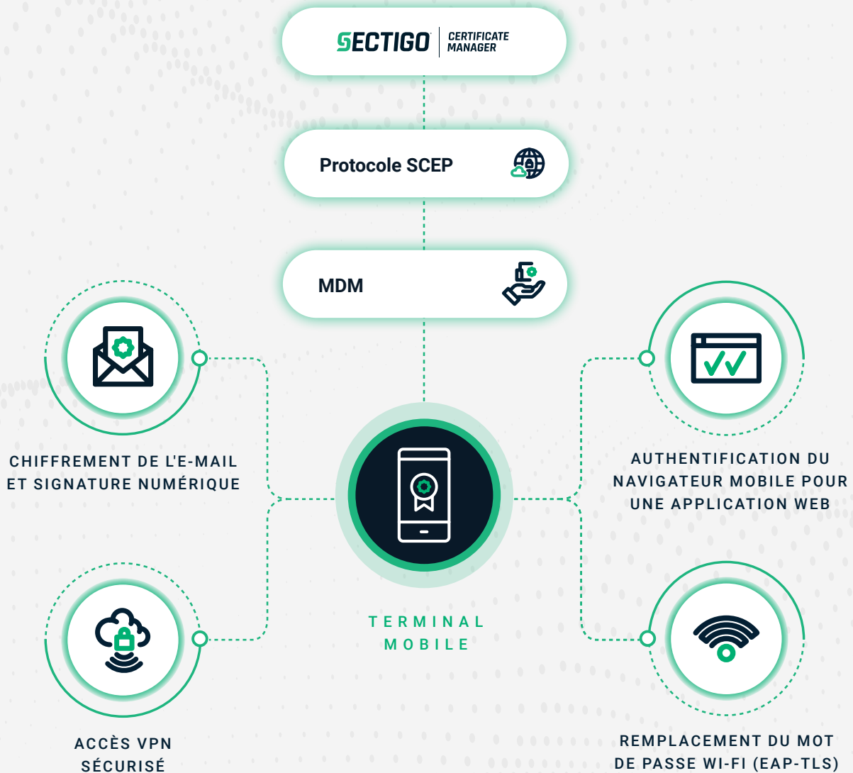
Figure 4 – SCM utilise SCEP pour transmettre les certificats au MDM, qui les installe sur le terminal mobile
